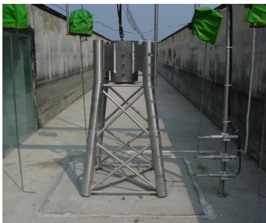
照片 1 基座柱体上压力计布置
